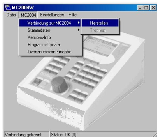
Sobald Sie am PC-Bildschirm dazu aufgefordert werden, müssen Sie nun an der Zentrale die Update-Prozedur starten. Diese Prozedur muss genau in der vorgegebenen Reihenfolge abgearbeitet werden.
